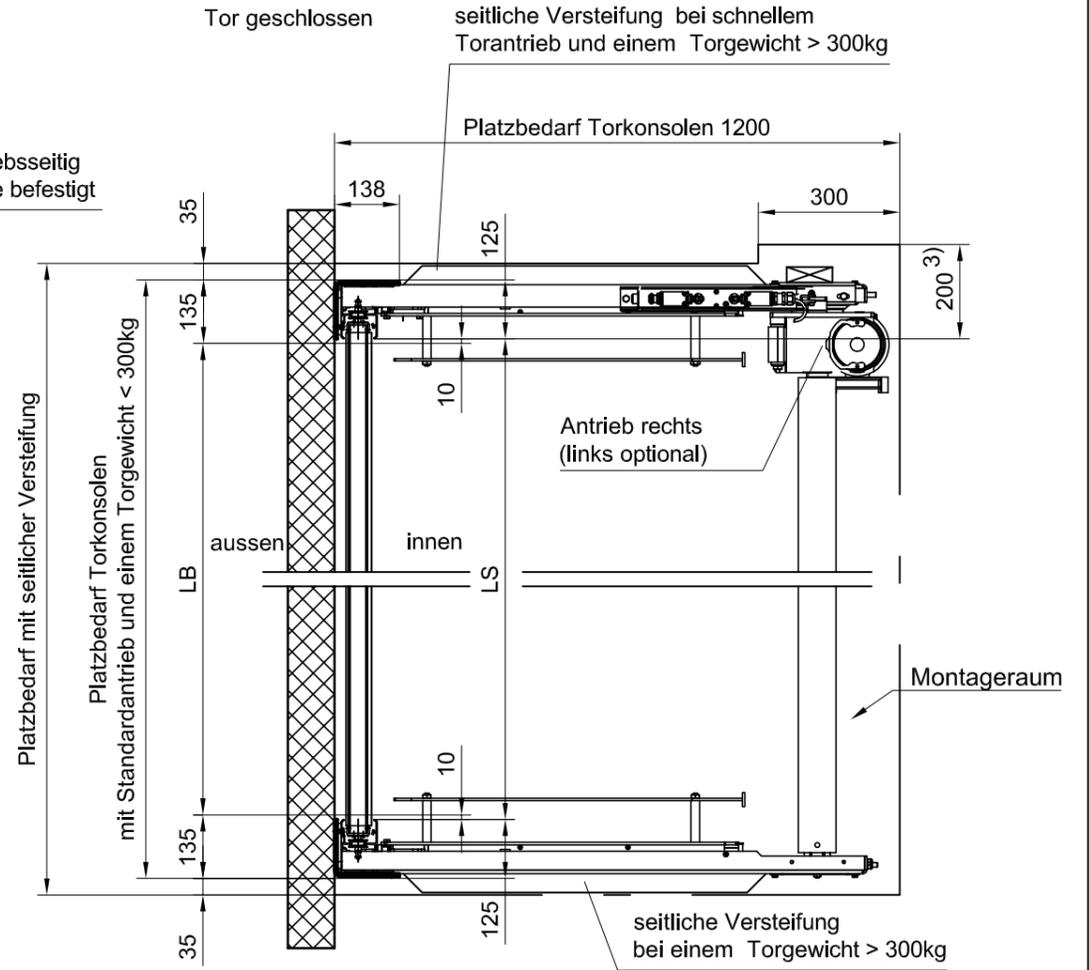
dargestellt ist die Standardbefestigung hinter der Leibung auf Stahlbeton, weitere Befestigungsmöglichkeiten siehe ST40 Befestigungsarten
