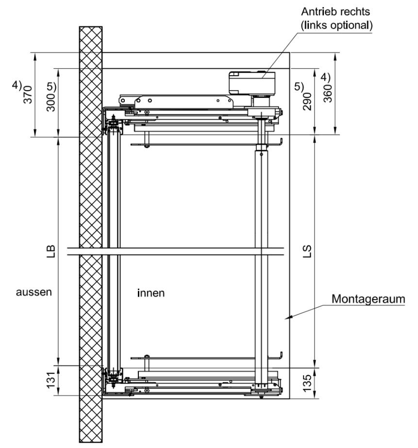
dargestellt ist die Standardbefestigung hinter der Leibung auf Stahlbeton, weitere Befestigungsmöglichkeiten siehe ST40 Befestigungsarten
