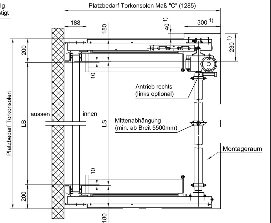
dargestellt ist die Standardbefestigung hinter der Leibung auf Stahlbeton
