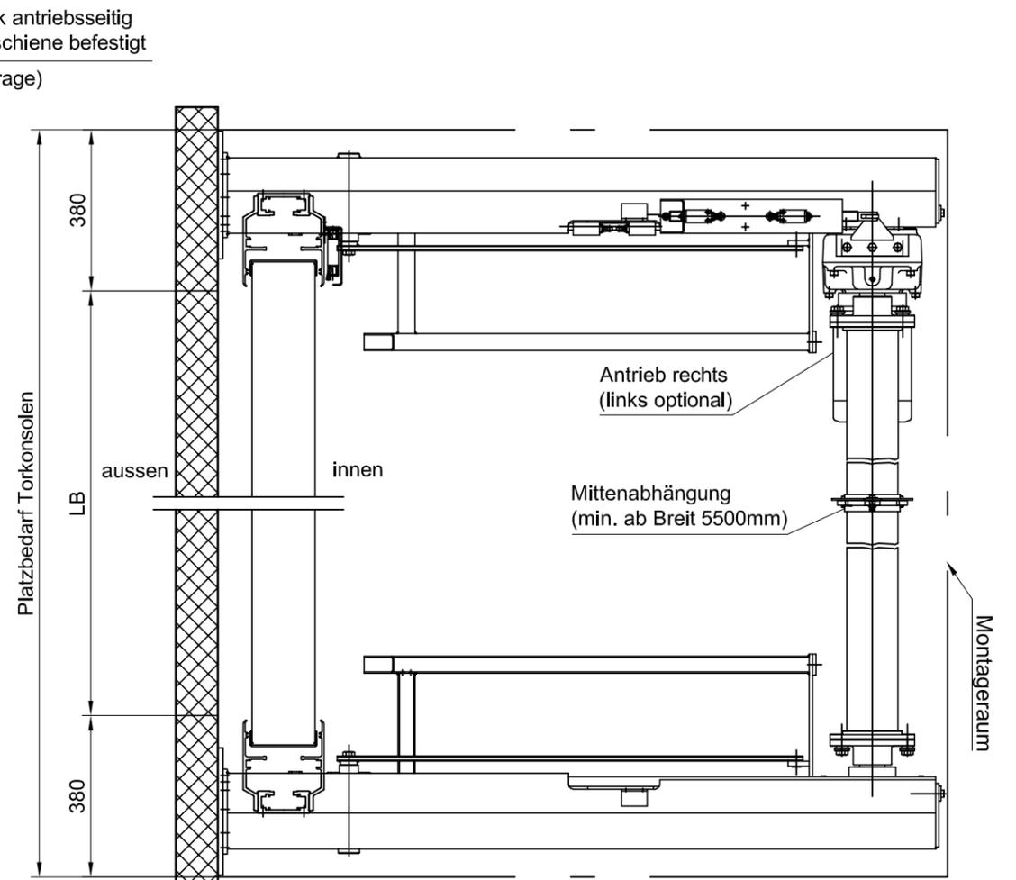
dargestellt ist die Standardbefestigung hinter der Leibung auf Stahlbeton
