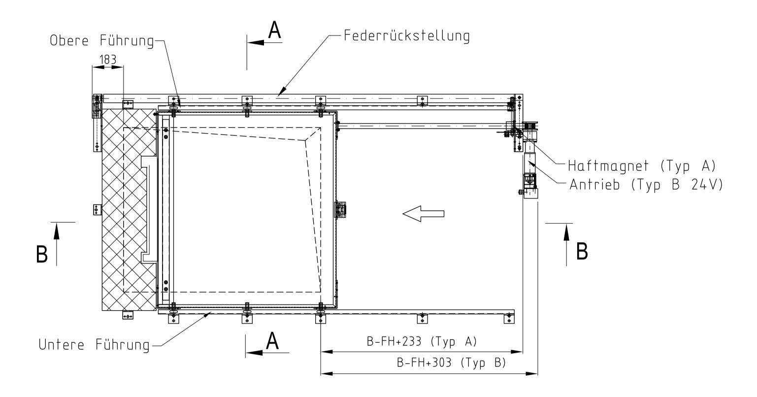
Bmax x Hmax = 2730 x 2730 (max. lichte Fläche 2,92m²) Abweichende Abmessungen auf Anfrage! <u>Wahlweise Ausführung mit Schließgewicht</u>
